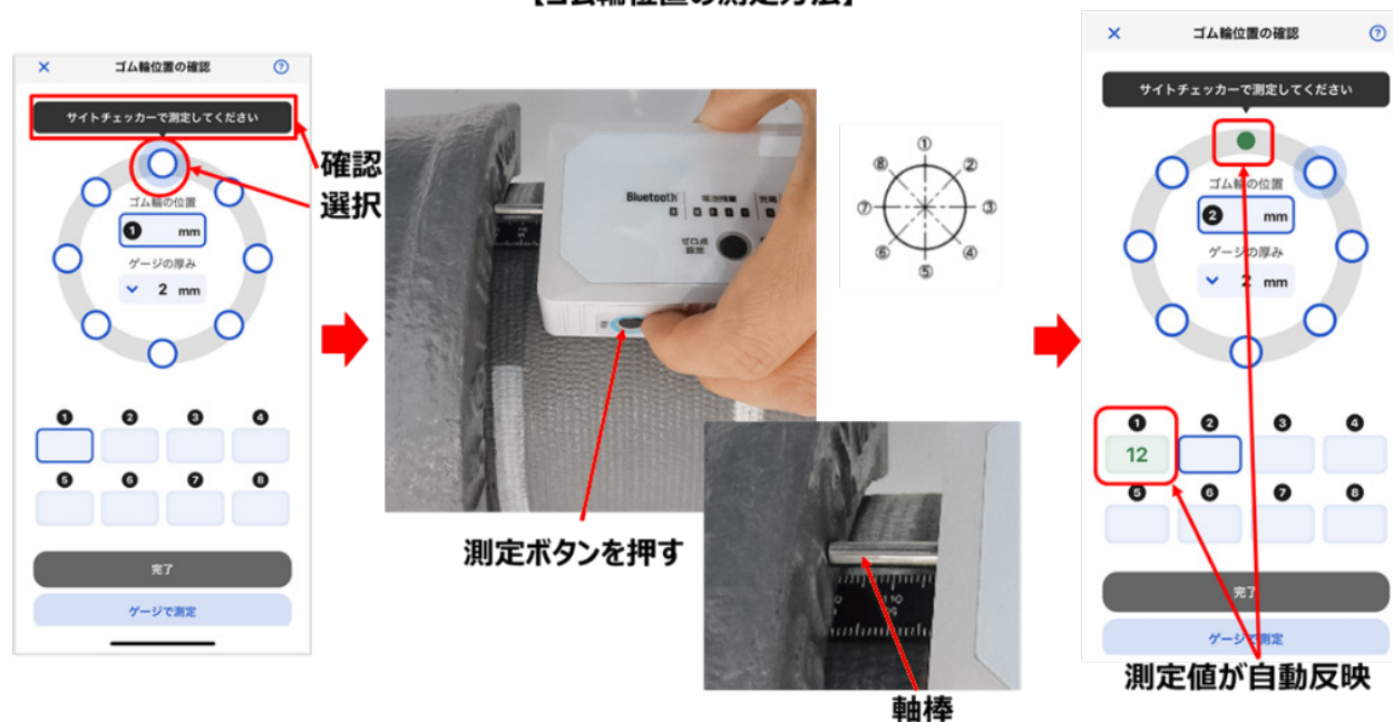
図 12 ゴム輪位置を測定する機器の使用手法
