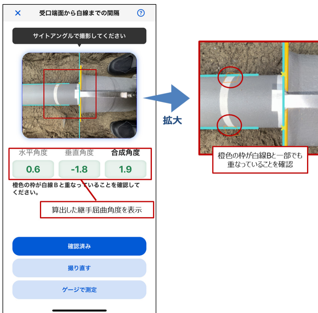
図 16 継手屈曲角度及び挿し口挿入量の確認
