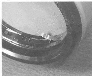
図 14 ストッパーの立ち上がり位置の確認
