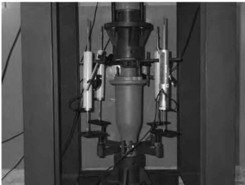
写真6 離脱防止性能試験状況
