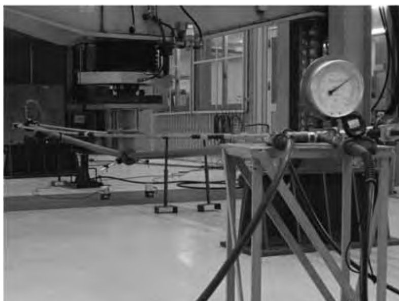
写真4 曲げ水密性試験状況
