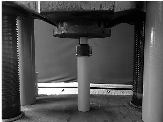
写真18 離脱防止性能試験状況 (直管)
