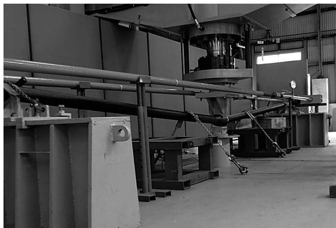
写真17 曲げ水密試験状況（直管）
