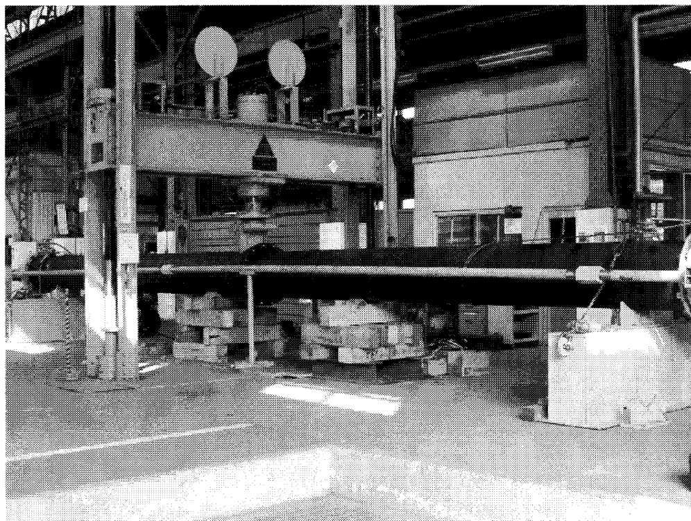
写真1 水密性試験状況(呼び径500 真直状態)
