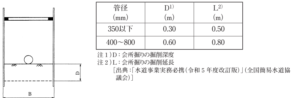
図2 土留めありの場合の掘削断面図
